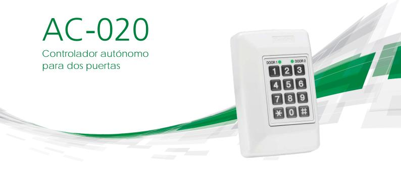
EL CONTROLADOR AC-020 ES UN EQUIPO COMPACTO Y FUNCIONAL EN SOLUCIONES PARA DOS PUERTAS. SOPORTA DOS LECTORAS (ENTRADA/ENTRADA), DOS CERRADURAS ELÉCTRICAS Y DOS ENTRADAS DE SOLICITUD DE SALIDA (REX). EL EQUIPO TIENE INTEGRADO LA FUENTE DE ALIMENTACIÓN PARA LAS CERRADURAS Y LECTORAS Y UN CARGADOR DE BATERÍA DE RESGUARDO.
