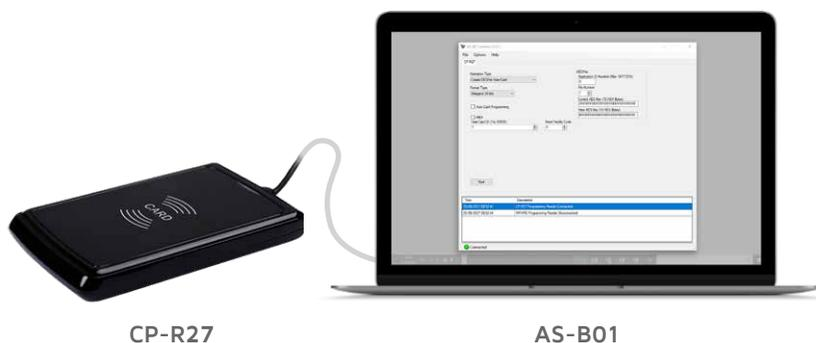
Utilizando Rosslare CP-R27 y su herramienta de configuración de software AS-B01, los instaladores y clientes pueden programar fácilmente sus credenciales seguras MIFARE® DESFire® EV1 y MIFARE Classic® EV1 Sector Read in situ, así como crear tarjetas de configuración para ajustar sus lectores.
